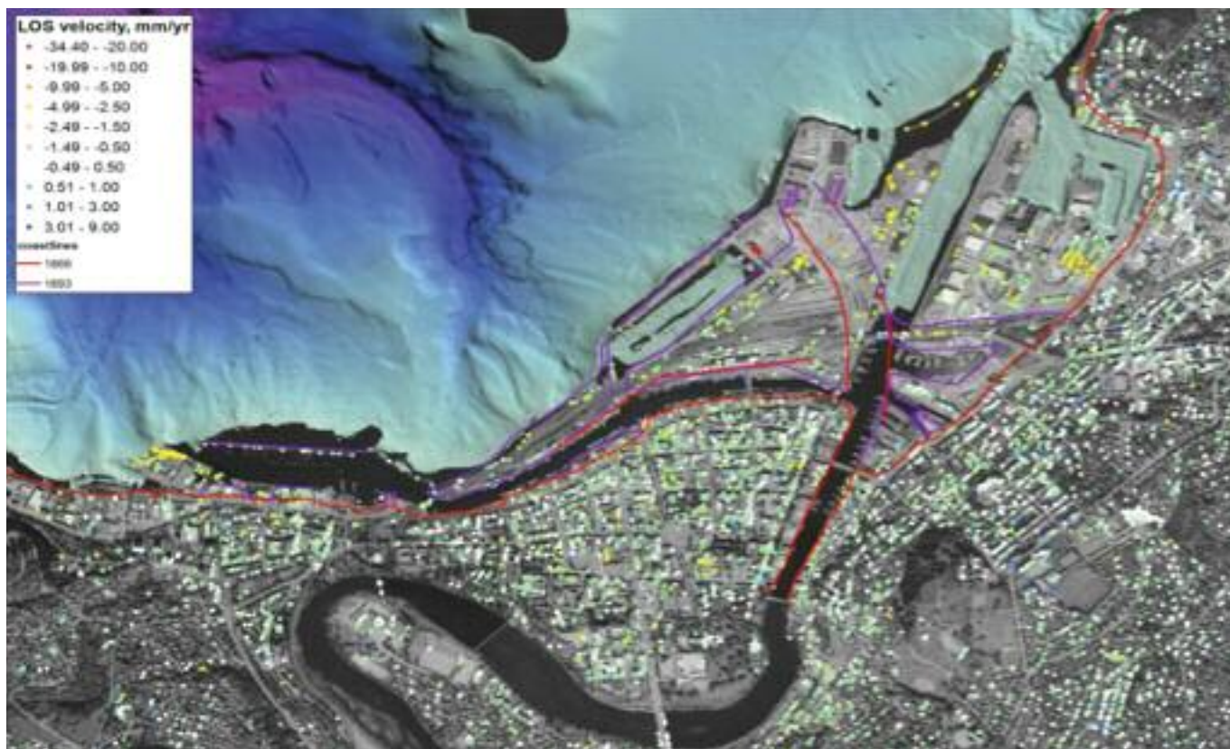
Figur 2.1. InSAR-kart over Trondheim sentrum basert på ERS SAR-data fra perioden 1992-2003. Havneområdet kommer fram som det området som beveger seg mest, med 1-2 cm i året i denne perioden. (NGU)
