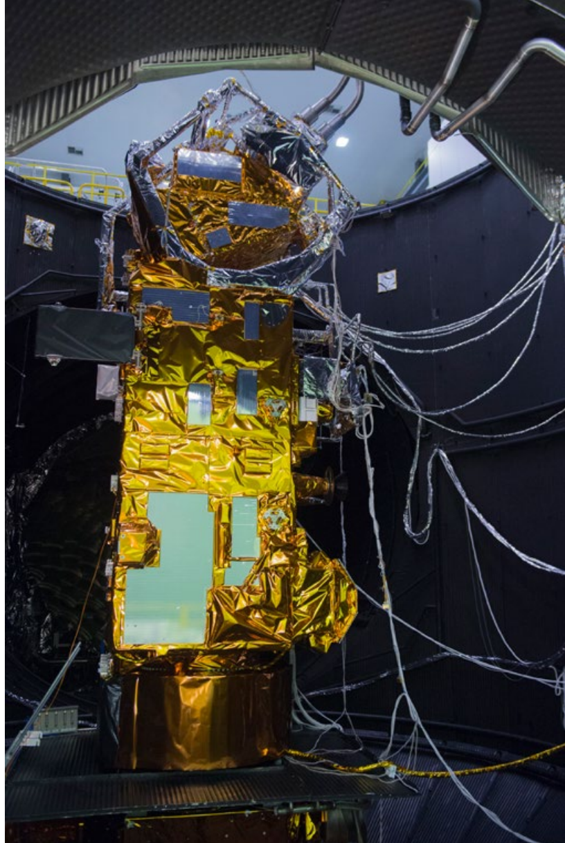
Værsatellitten MetOp-C testes for ekstrem kulde i vakuum før oppskyting. © ESA/G. Porter
